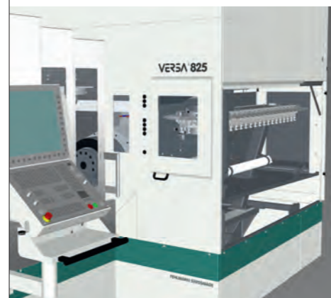
Grundausführung Kettenmagazin mit 44 Werkzeugen
