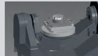
Integriertes Adaption Kit UPC/PCP: Ø = 148 mm
