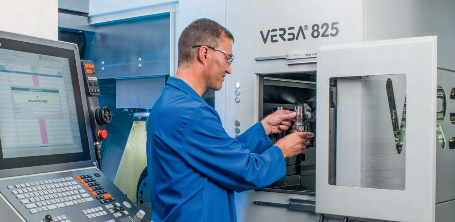
VERSA 825 mit Paletten-Handlings-system ERE auf der linken Seite und rechts mit Regalmagazin für bis zu 250 Werkzeuge (Optionen).
