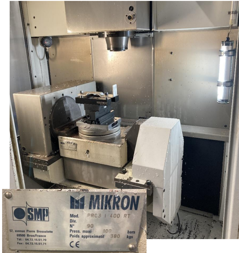
Maschine-Arbeitsraum mit A/C-Achse Dreh-Schwenk-Einheit workspace of machine with A/C-axis tilt/rotary stage
