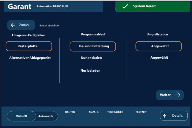
Abb. 21: Ablage von Fertigteilen, Programmablauf und Umgreifstation
