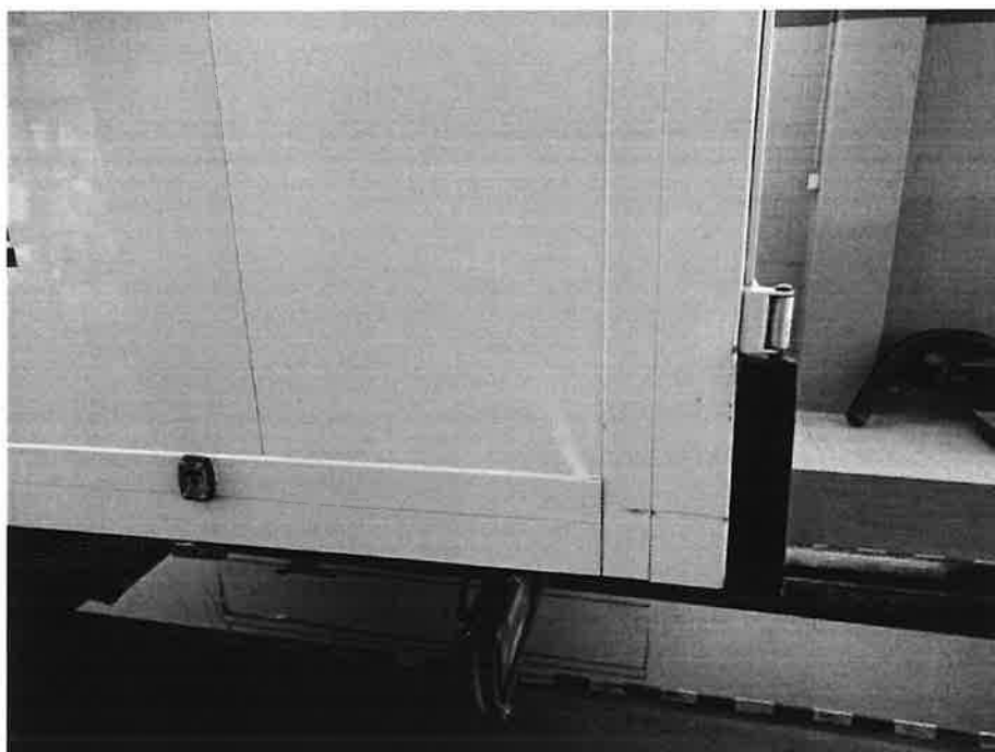
Bild 11 : Koffer hinten links mit Rampenanschlag deformiert
