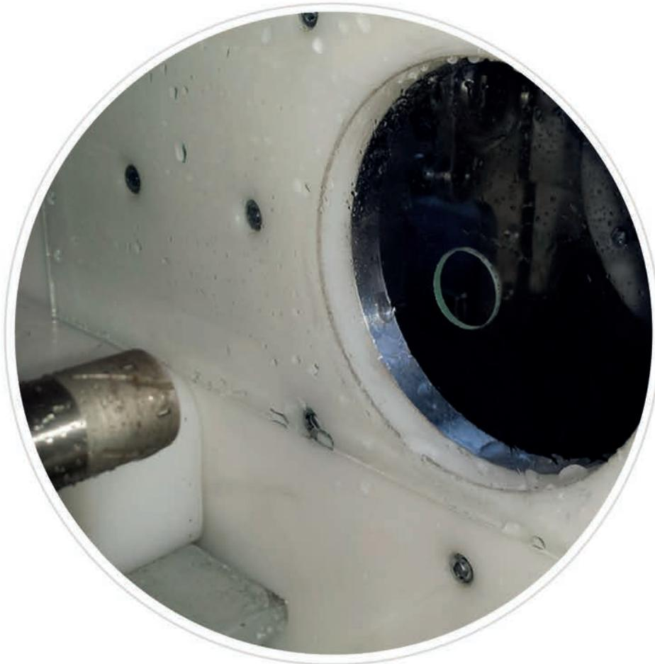
Eine Öffnung von 2 mm im Glas, ohne manuelle Änderung von Parametern, gemacht direkt nach dem Bohren von Glas 10 mm. Die Glasdicke, die Bohrtiefe und die Bohrgeschwindigkeit sind von der Bohrmaschine automatisch angepasst worden.
