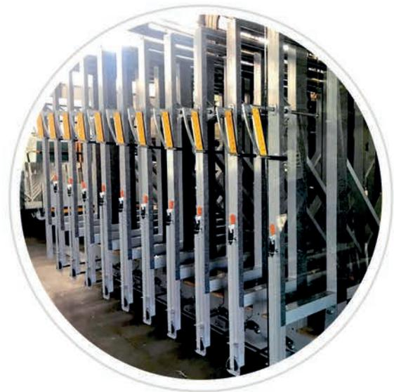
Die (seitlich ausziehbaren) **E X P O G L A S S<sup>®</sup>** Lagersysteme dienen der Lagerung von Plattenwerkstoffen und werden seitlich auf Schienen ausgezogen.
