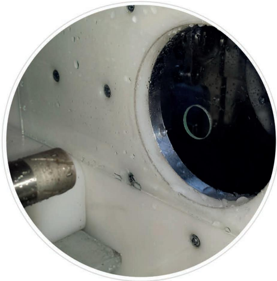
Agujero en vidrio de 2 mm realizado sin cambios manuales de los parámetros realizados directamente después de taladrar el vidrio de 10 mm. El espesor del vidrio, la profundidad y la velocidad fueron ajustados automáticamente por la máquina.
