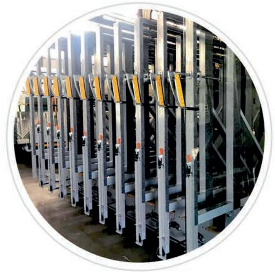
Les racks de type R (ouverture latérale) E X P O G L A S S<sup>®</sup> sont des systèmes de stockage de panneaux, à ouverture latérale sur rails.
