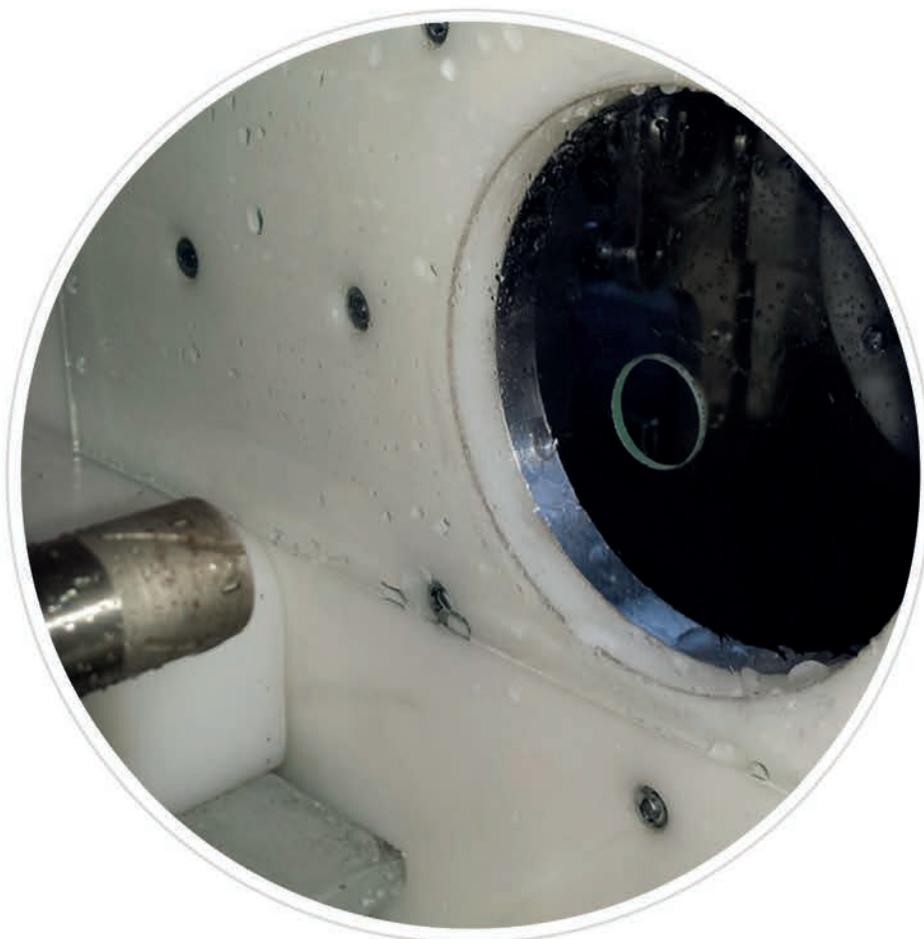
Trou dans un verre de 2 mm réalisé sans modification manuelle des paramètres, immédiatement après avoir percé un verre de 10 mm. L'épaisseur du verre, les profondeurs et les vitesses ont été réglées automatiquement par la machine.
