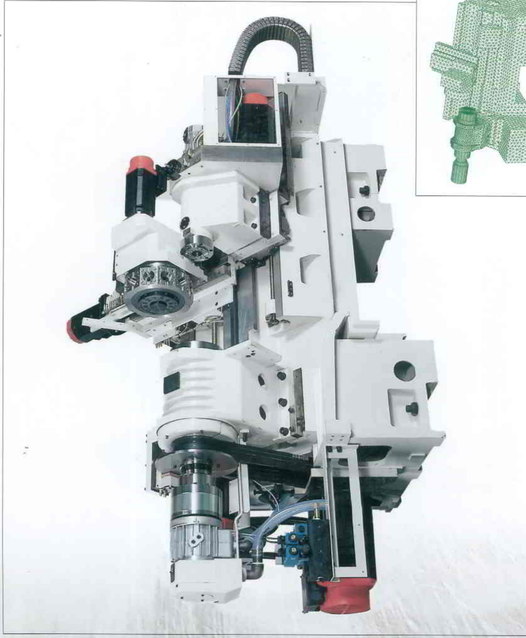
Per progettare una struttura stabile viene impiegata l'analisi FEM. (FEM:Metodo Elementi Finiti)
