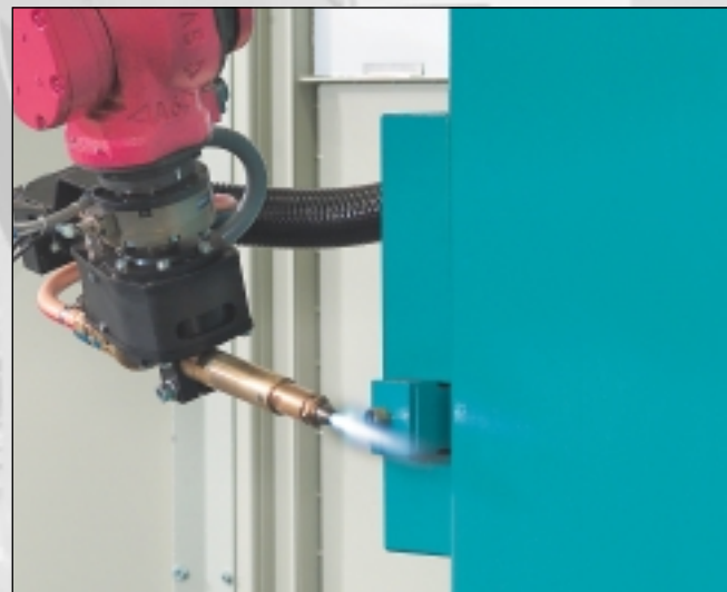
Automatische Flammzündeinrichtung über Zündbrenner am Portal.
