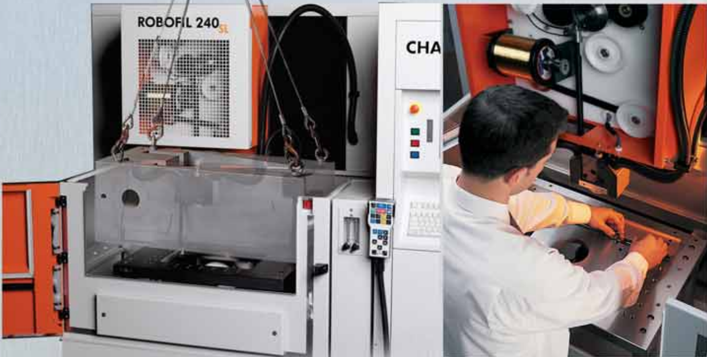
Große UV-Verfahrwege, um Beladung mittels Kran zu erleichtern
