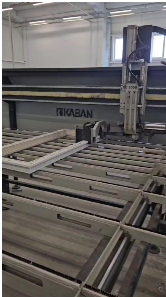
4-главова заваръчна машина за ПВХ профили — заварва едновременно четирите ъгъла на рамката при 90°.
