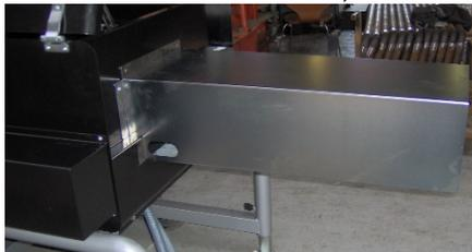
Abdeckung am Einlauf montieren
