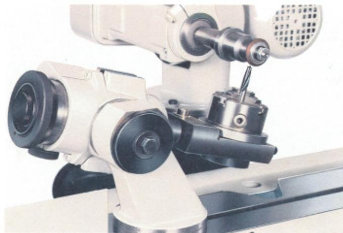
Schleifen von Bohrern mit Zentrierspitze.
