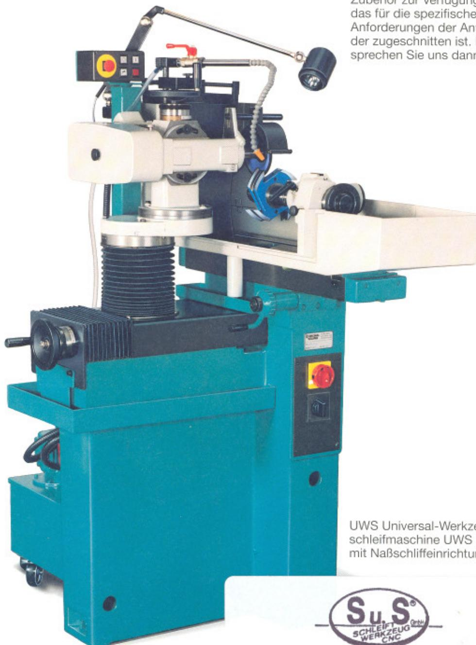
UWS Universal-Werkzeugschleifmaschine UWS 71 U mit Naßschliffeinrichtung.
