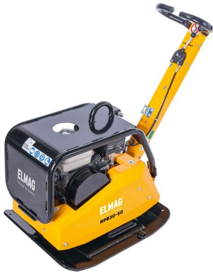
mit Honda-Motor GX200, 30 kN Zentrifugalkraft, mit Schutzrahmen aus Stahl
