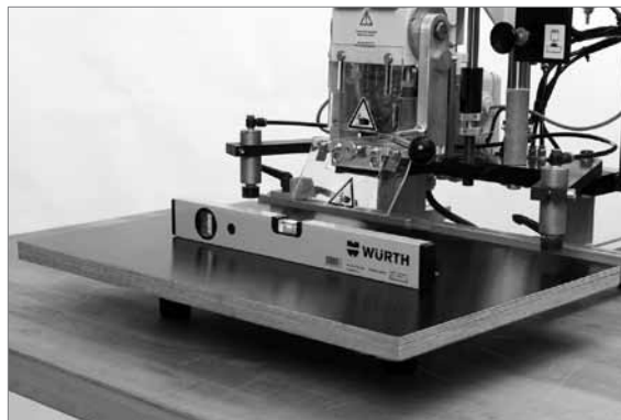
Maschine mit Wasserwaage Ausrichten.
