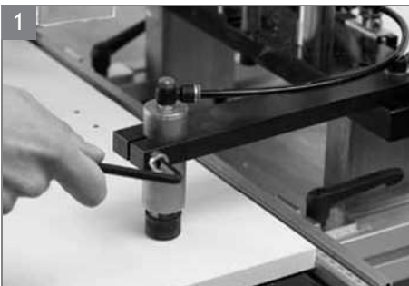
Niederhalter lösen und herausnehmen.
