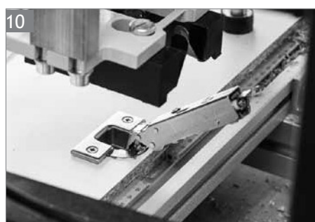
Scharnier einlegen, Handhebel nach unten.
