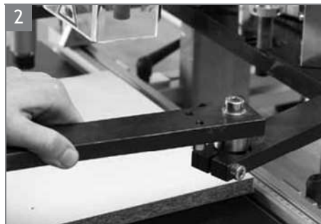
Niederhalterverlängerung in das Loch einführen und festziehen.
