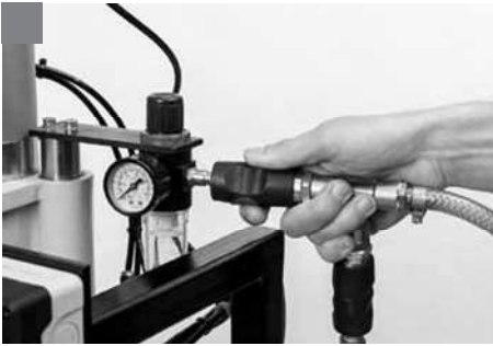
Maschine von Druckluft trennen.
