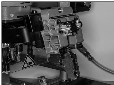
Scharnier einlegen, Handhebel nach unten.
