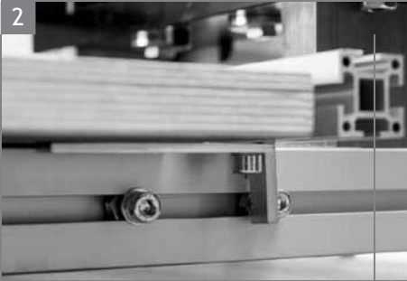
2 Klemmhebel lösen, Tisch nach hinten drücken.
