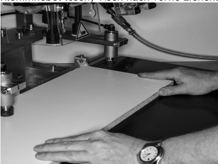
Werkstück an Anschlag drücken.
