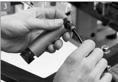
Verlängerten Druckluftschlauch an Niederhalter einstecken.
