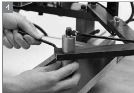
Niederhalter in die Verlängerung einsetzen und auf Werkstückhöhe einrichten.
