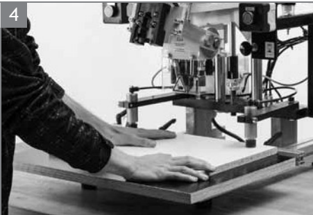
4 Werkstück an Anschlag drücken.
