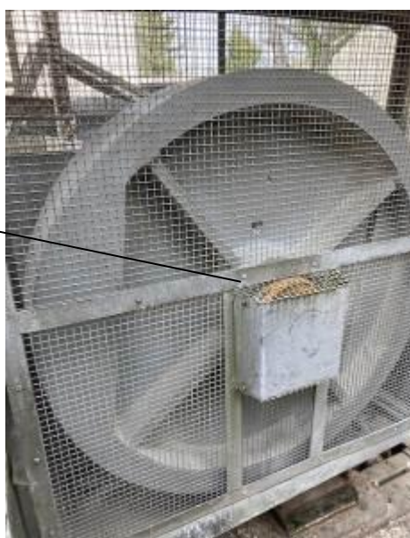
Fig. XIV Autre vue volant entraîneur, carter grillagé
