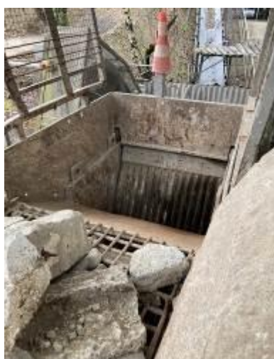
Fig. XVII Vue de la goulotte admission matériau sur gueulard
