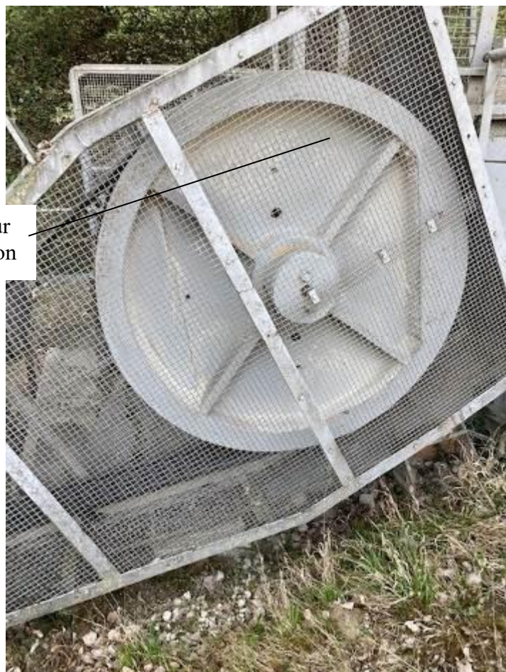
Fig. XIV Autre vue volant entraîneur, carter grillagé
