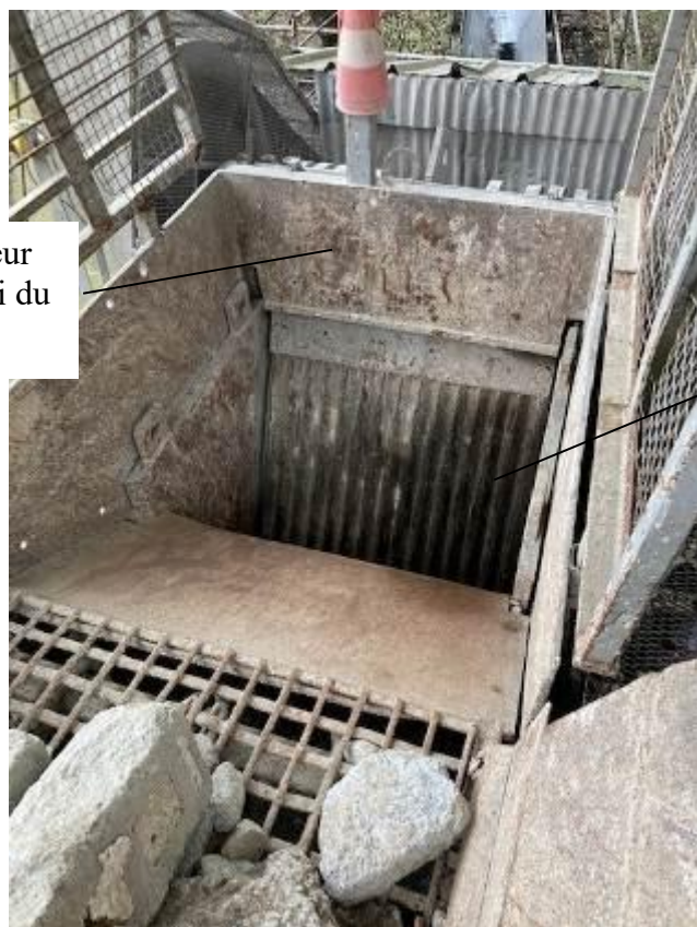
Fig. XVI Vue gueulard concasseur et goulotte liaison entre le scalpeur et les mâchoires mobile et fixe
