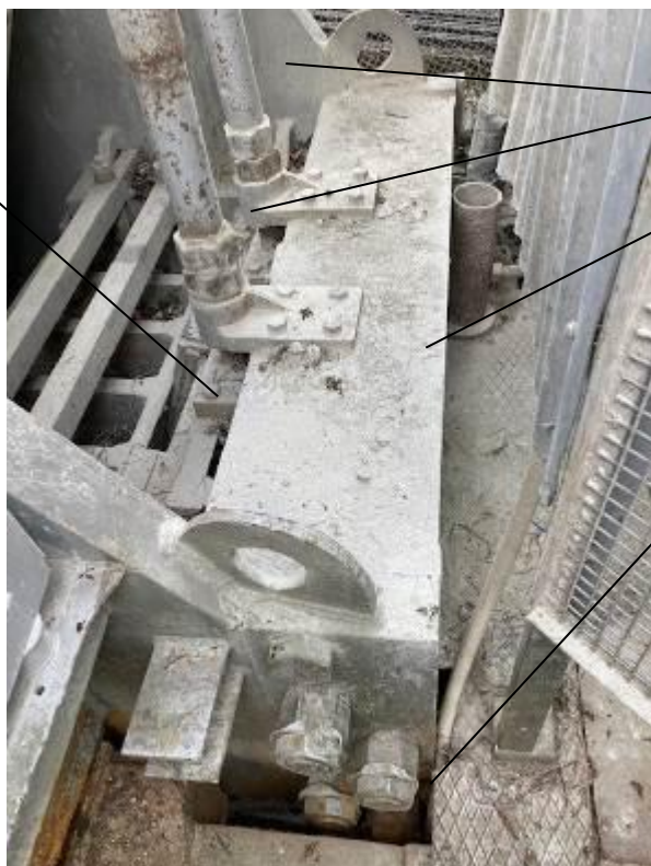
Fig. XII Vue de la paroi arrière, boulonnée aux parois latérales de la carcasse, deux vis de réglage de l'ouverture et bloc compact
