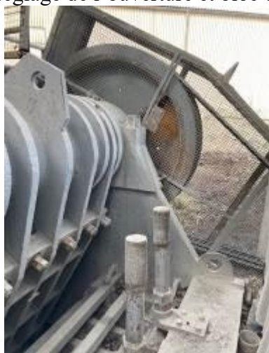
Fig. XIII Vue arrière de la bielle, paroi latérale carcasse côté volant entraîneur, volant entraîneur, carter grillagé de protection des courroies, deux vis de réglage de l'ouverture entre mâchoires
