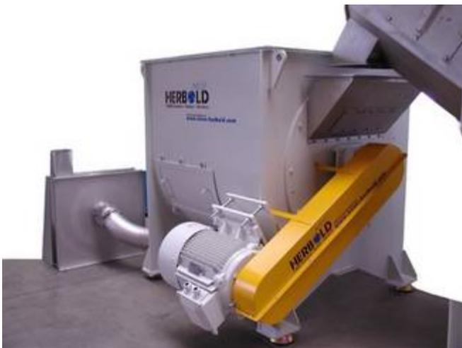
Der Rotor ist dynamisch gewuchtet. Robuste, außerhalb des Gehäuses angeflanschte Pendelrollenlager garantieren einwandfreien Lauf der Maschine. Auf Wunsch kann der Rotor mit auswechselbaren Verschleißplatten versehen werden.
