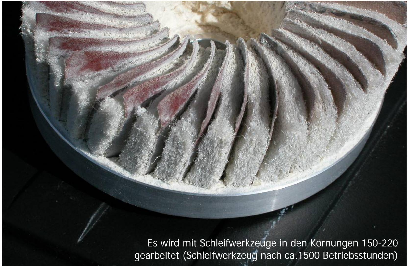
Es wird mit Schleifwerkzeuge in den Körnungen 150-220 gearbeitet (Schleifwerkzeug nach ca.1500 Betriebsstunden)
