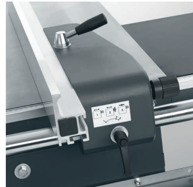
Parallelanschlag mit manueller Feineinstellung.
