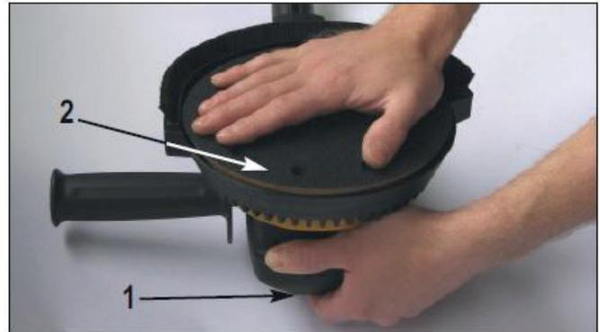
**Tip:** Ziehen Sie den Schleifteller von Hand an, so ist er später einfacher zu lösen.
