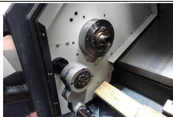
Ansicht Hauptspindel und Teilefänger
