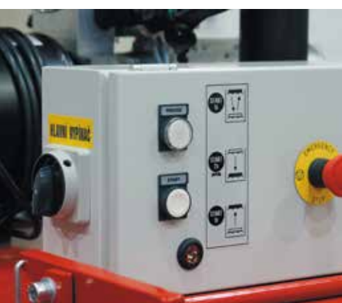
Všechny elektronické bezpečnostní prvky jsou propojeny dvojitou elektroinstalací
