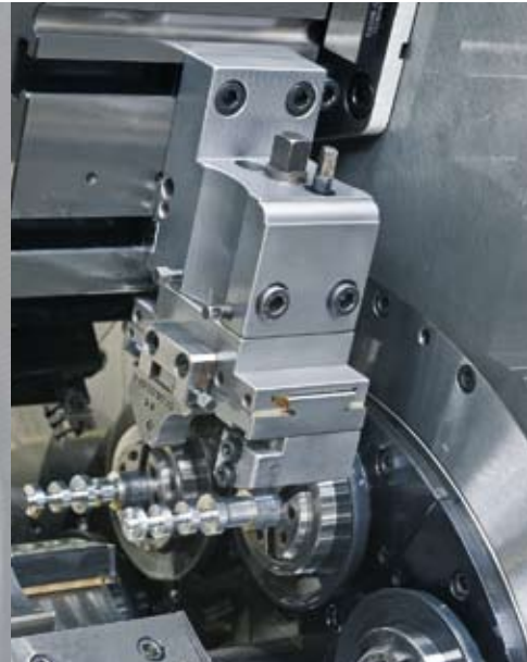
Umfangreicher Ausrüstungsbaukasten z.B. für umlaufendes Fräsen (oben links), Gewindebohren und Profildrücken (oben rechts), tangenciales Schlichten (mitte rechts) und Mehrkantschlagen (S. 11)
