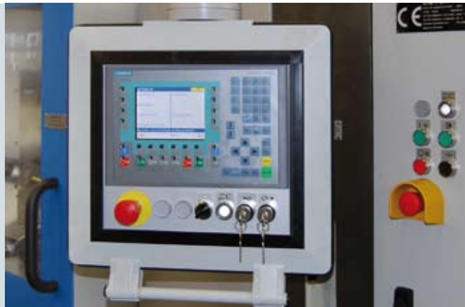
Schwenkbares Bedienpult für beide Maschinenseiten
