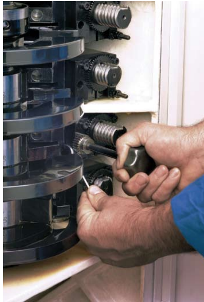
Einstellen einer Längsschlitzenkurve – Stufenlos verstellbar und gut zugänglich
