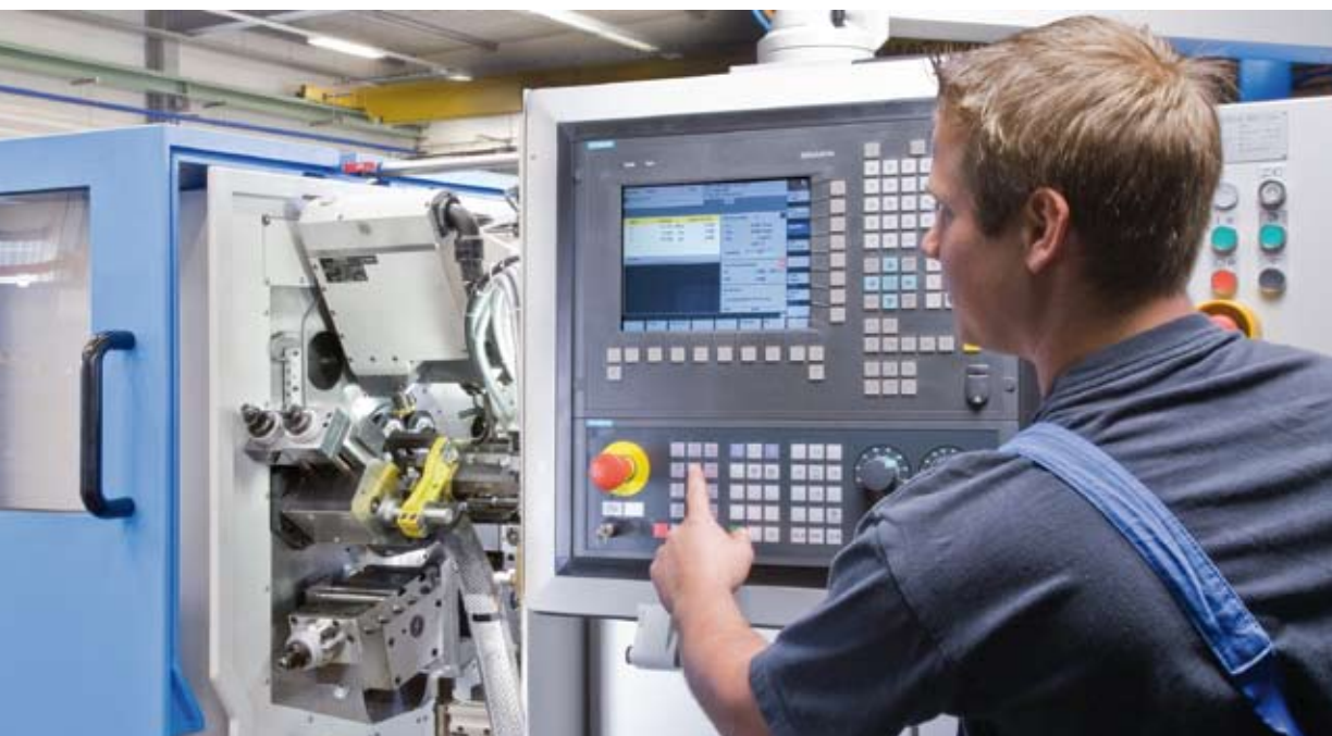
SG 18 und AG 20 – Kurvengesteuerte Mehrspindel-Drehautomaten mit Optionen für CNC- Bearbeitungen
