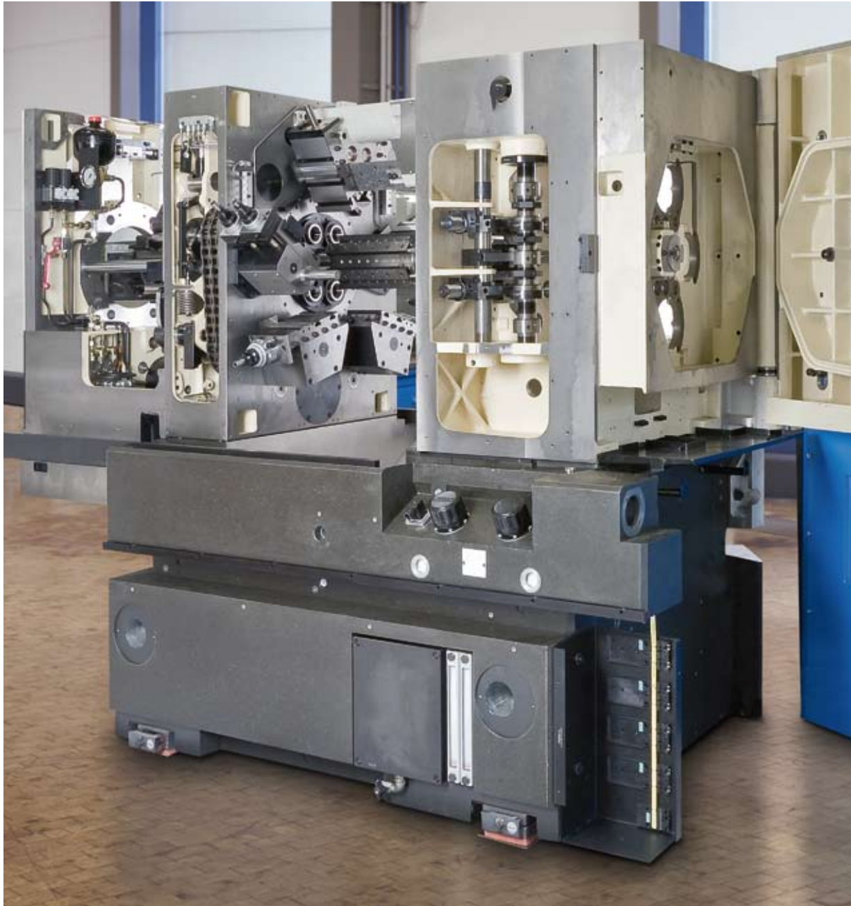
Grundaufbau der SG 18 nach klassischer Bauart Schütte
