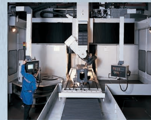
Planschleifen der Führungen
