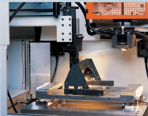
Integrierte Automatisierung für Palettenwechsel bis zu 100 kg
