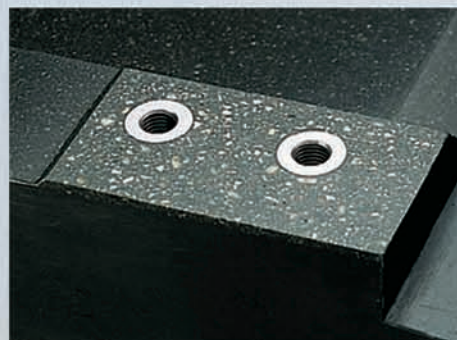
Polymerbetonrahmen zwecks höherer thermischer Stabilität
