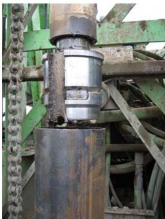
Il symmetrix consente di perforare pozzi utilizzando tubi d'acciaio o PVC . Raggiunta la profondità necessaria, la punta pilota viene sganciata e si recupera la batteria interna. Il tubo viene poi cementato per evitare che acqua superficiale possa contaminare il pozzo.
