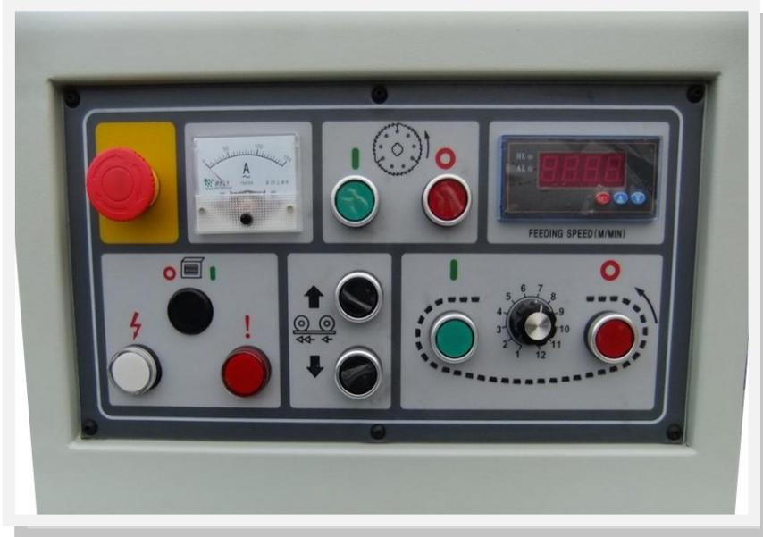
Digitalanzeige für Zufuhrsgeschwindigkeit
