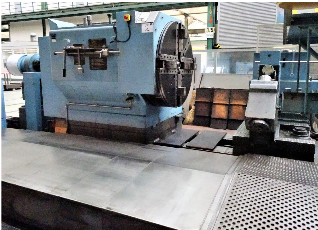
Spindelstock mit Hauptantrieb, C Achse und Planscheibenklemmung
