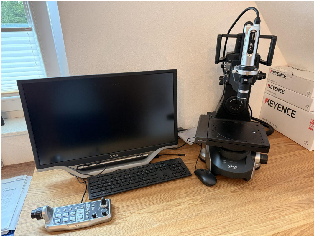
Gesamtansicht: Monitor, Mikroskopeinheit mit Kamera und Optik, motorisiertes Stativ und Bedienkonsole
