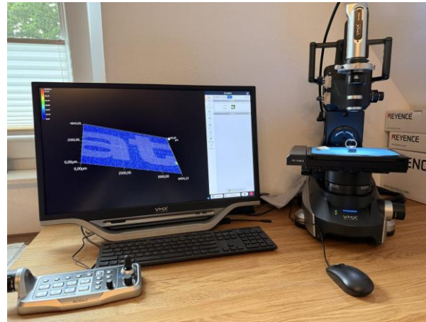
3D-Profilmessung (Softwaremodul VHX-H6M): Höhen- und Topografiedarstellung
