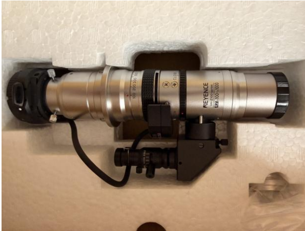
Hochleistungsoptik VH-Z100 (Vergrößerung x100–1000)
