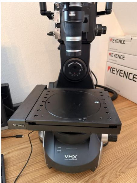
Motorisiertes Stativ VHX-S770E mit großem Objektisch (XY-Tisch)
