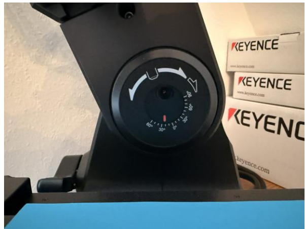
Motorisierter Schwenkkopf mit Winkelskala 0–90°
