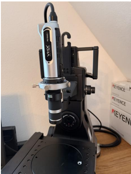
Kameraeinheit VHX-7100 mit Wechseloptik am motorisierten Kopf
