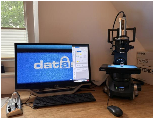
Live-Betrieb: Probe auf der beleuchteten XY-Stage, Echtzeitbild am Monitor
