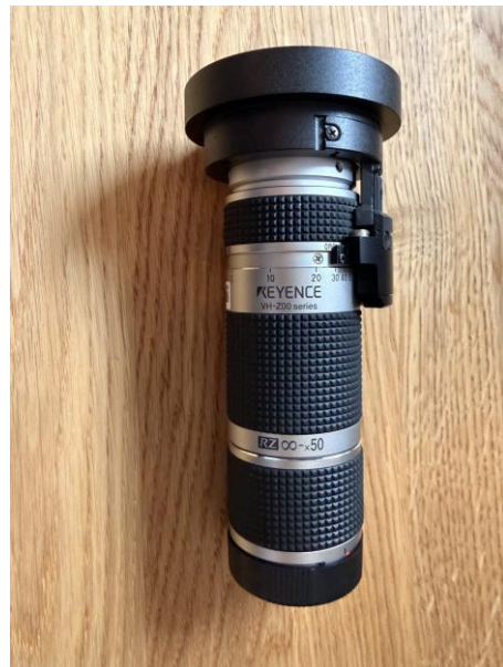
Objektiv VH-Z00T · VH-Z00 series RZ ∞-x50 (Vergrößerung bis x50)
