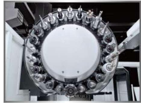
24T Werkzeugmagazin vom Typ Disc
