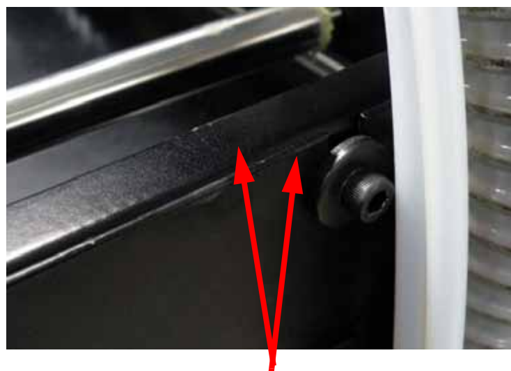
Align top edge of XY table with top edge of frame
