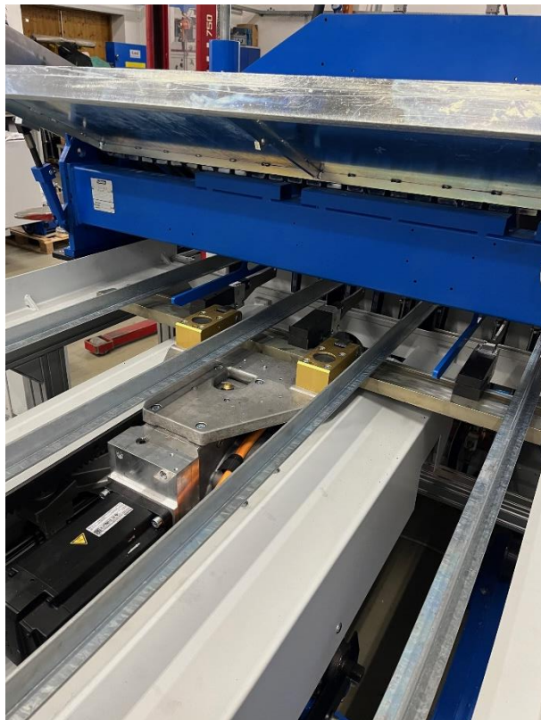
Abbildung 8: MVL Mattenauszug mit drei Mattengreifern
