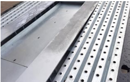
Rosettenblech im Fahrgassenbereich
