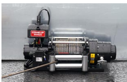
Seilwinde 8.165 kg Zugkraft
