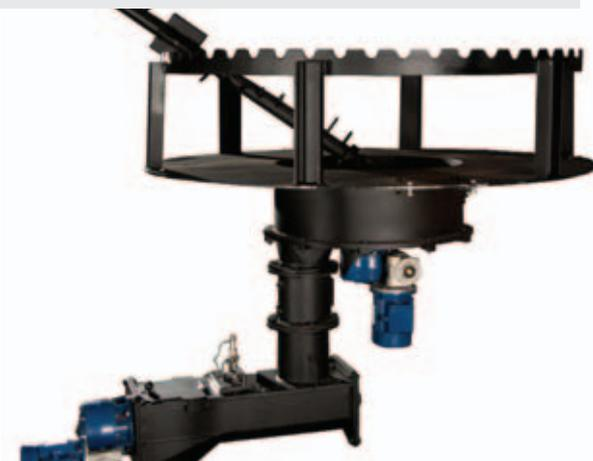
Einsatz hauptsächlich als Siloaustragschnecke in der Holzverarbeitenden Industrie. Sorgt für eine gleichmäßige und zuverlässige Brennstoffaustragung aus Hochsilos.
