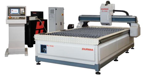
CNC Plasma- und Brennschneidanlagen für eine breite Palette von Baustahl, Edelstahl und Aluminium
