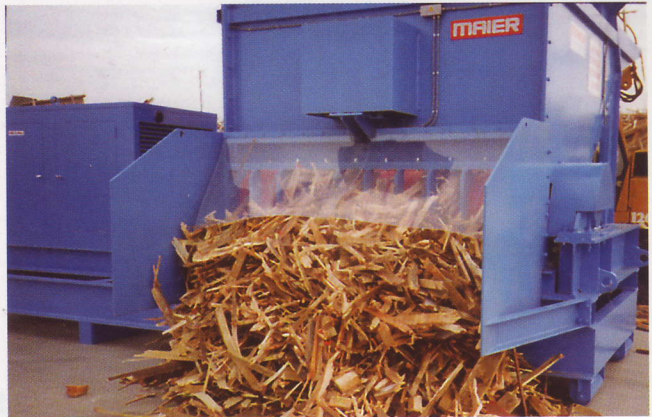
Vorgebrochenes Material am Austrag eines semimobilen MGB's
