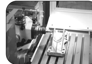
HORIZONTALE POSITION (FEST) Der Spindelkopf ist mit einem Präzisions-Indexierbolzen gesichert. Spindelstock und Gegenhalter in unterer Position. Spindel zu Tisch: 65-540 mm
