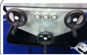
ELEKTRONISCHE HANDRÄDER 3 Handräder für die X-, Y- und Z-Achse elektronisch gesteuert (vorne am Tisch montiert). Diese Option ersetzt das elektr. Handrad HR 510
