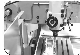
VERTIKALE POSITION (FEST) Der Spindelkopf ist mit einem Präzisions-Indexierbolzen gesichert. Spindelstock und Gegenhalter in oberer Position. Spindel zu Tisch: 20-495 mm
