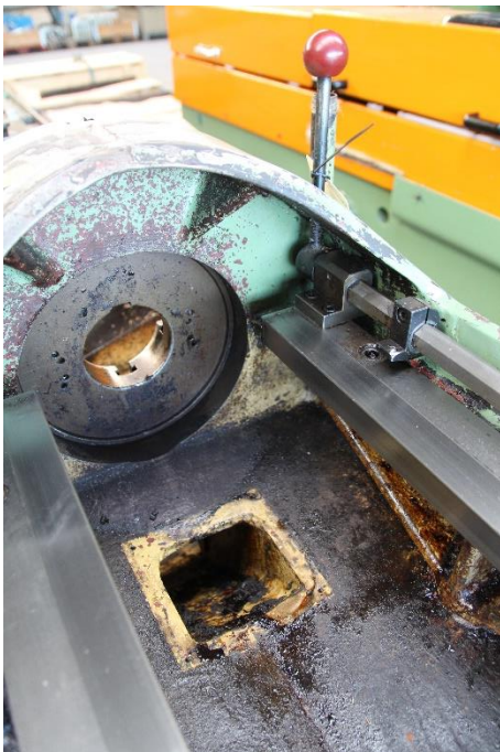
Rückseite Werkstücktisch mit Räumhub- Auslösung
