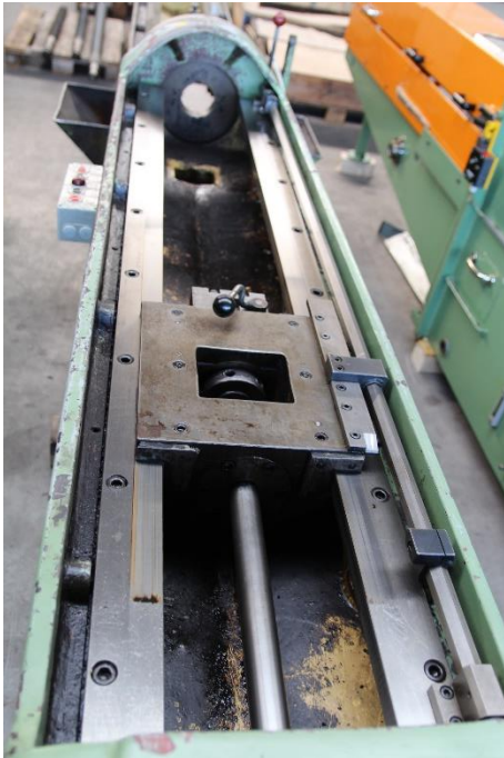
Zugbrücke mit Ziehkopfaufnahme & Kolbenstange
