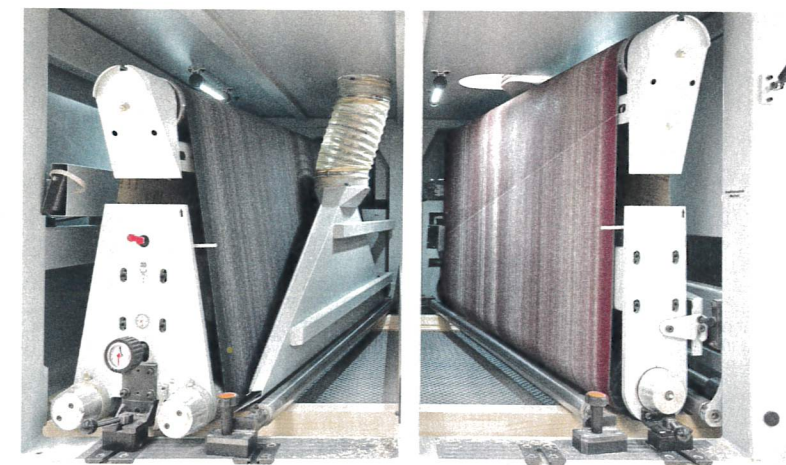
VMax für volle Arbeitsbreite: Die schwenkbaren Aggregate erzeugen einen diagonalen Kreuzschliff auf Längs- und Querriesen.
