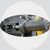
Hidrolik Şerit Gerdirme Hydraulic Blade Tensioning
