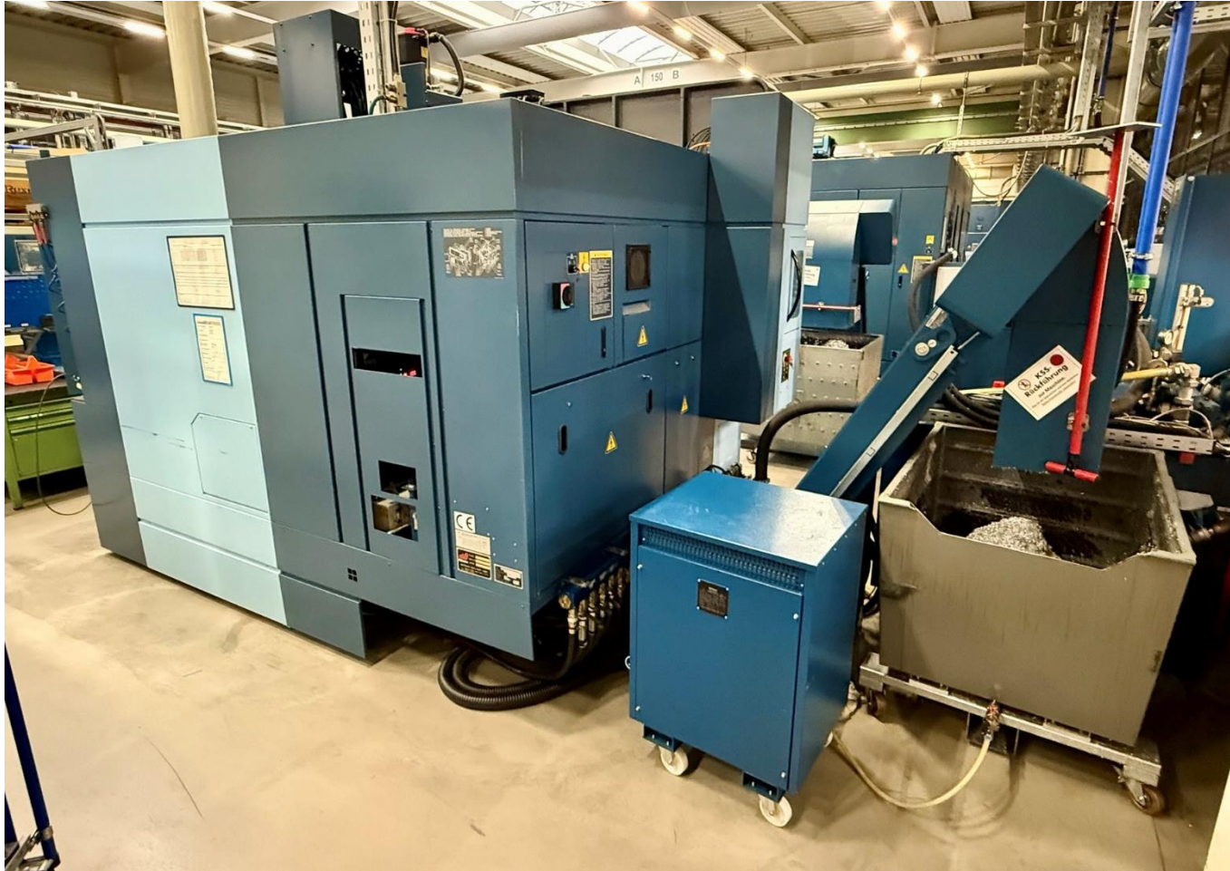
Rechte Seite / Rückseite / Späneförderer / Trafo
