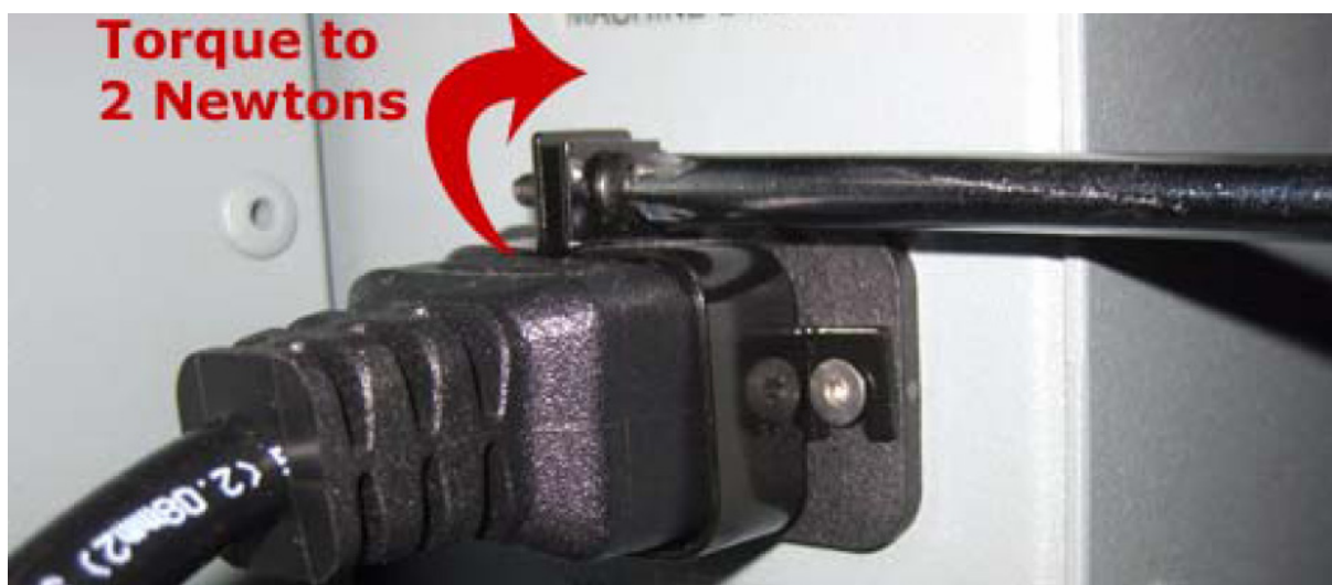
Abbildung 16: Klemmsicherung an der Steckkupplung
