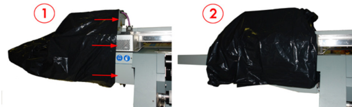
Abbildung 18: Beispiel für die Verhüllung des Wartungsbereichs als Lichtschutz
