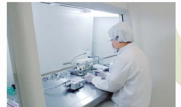
Montaż głowic tnących wykonywany jest na „czystym stole”
