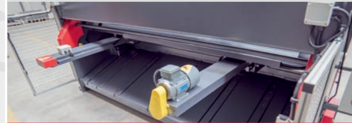
Motorischer Hinteranschlag mit einer Genauigkeit von \pm 0,1 mm
