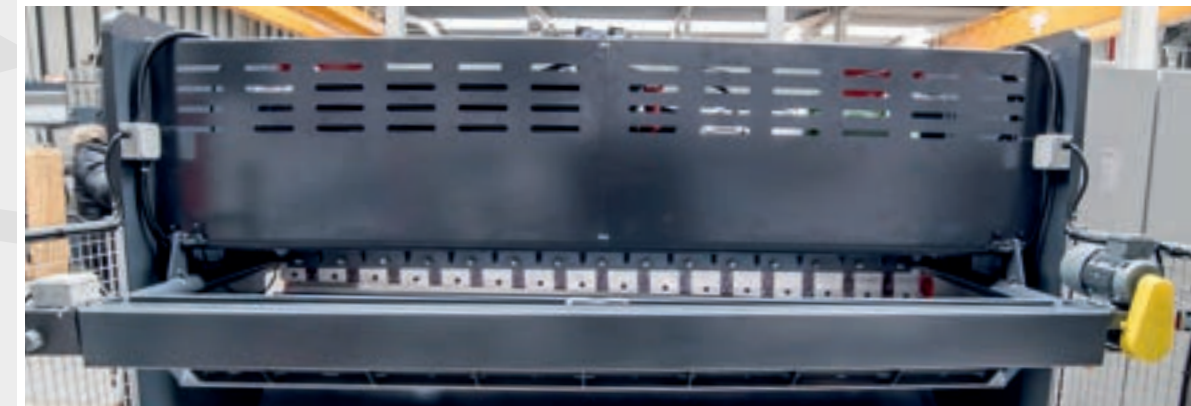
Motorischer Hinteranschlag mit einer Genauigkeit von \pm 0,1 mm
