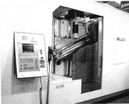
Abbildung 6-7 Schwenkachse
