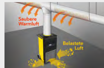
DualHeat-Ausblasturm für gleichmäßige Warmluftverteilung
