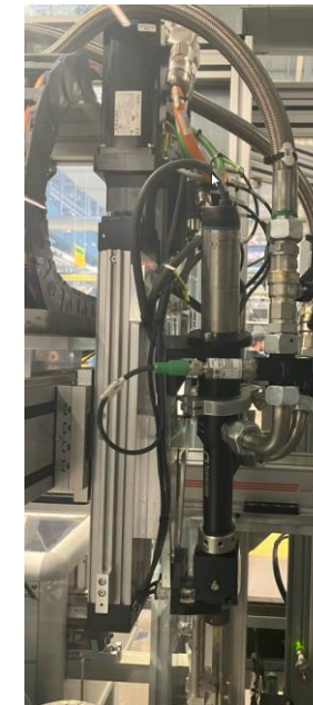
Mischrohr für Zweikomponentenkleber mixing tube for two-component adhesive
