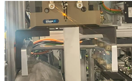
Greifer Housing mit Gummierung Gripper housing with rubber coating
