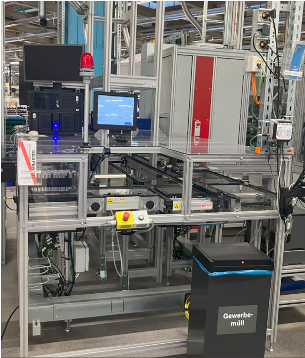
Ausschleusband + Pufferstrecke zur manuellen Nachbewertung der Vision
