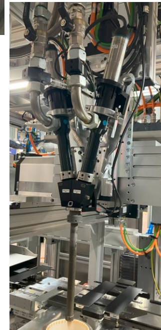
Mischrohr für Zweikomponentenkleber mixing tube for two-component adhesive
